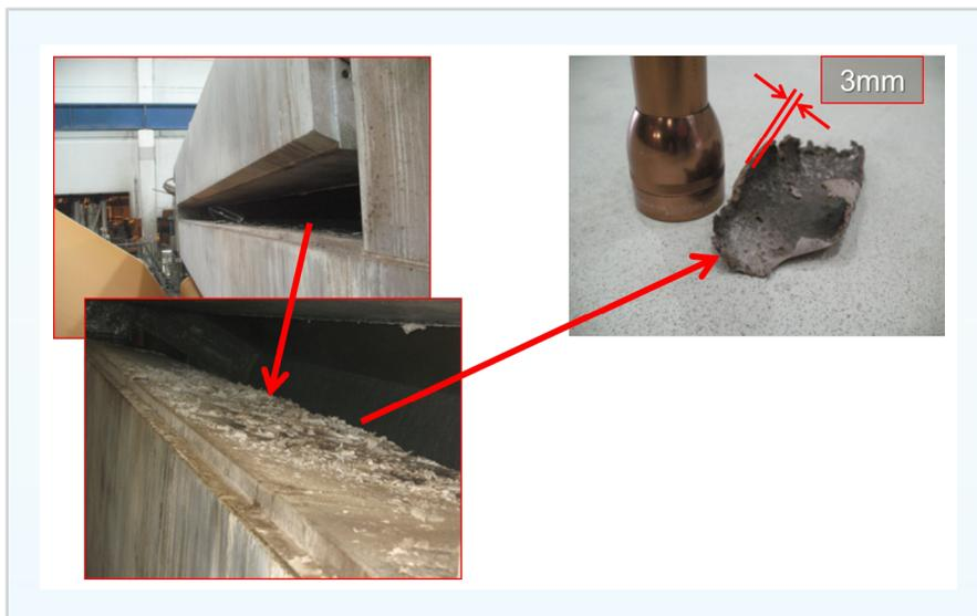
Figura 8: Exemplo de sujeira da máquina que pode adentrar o nip.
